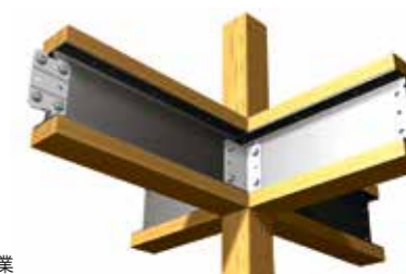
木と鉄の複合梁「テクノビーム」を用い構造設計を行う
